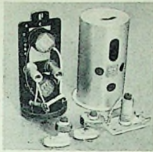
Bild 2. Zf-Kombinationsfilter (468 kHz, 10,7 MHz) und verschiedene Hf-Drosseln
